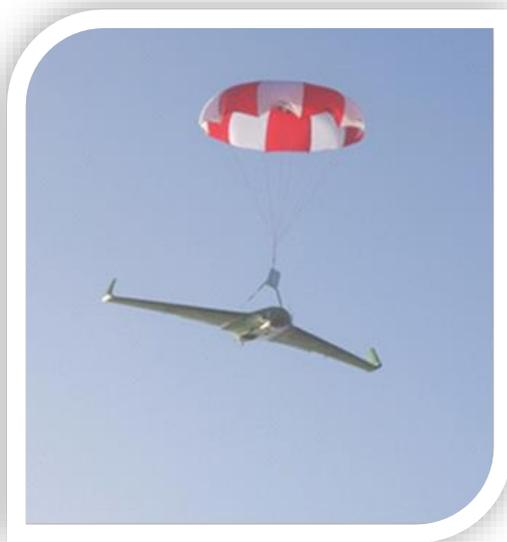
Figure 2. Le drone est équipé d'un parachute comme mesure supplémentaire de sécurité
